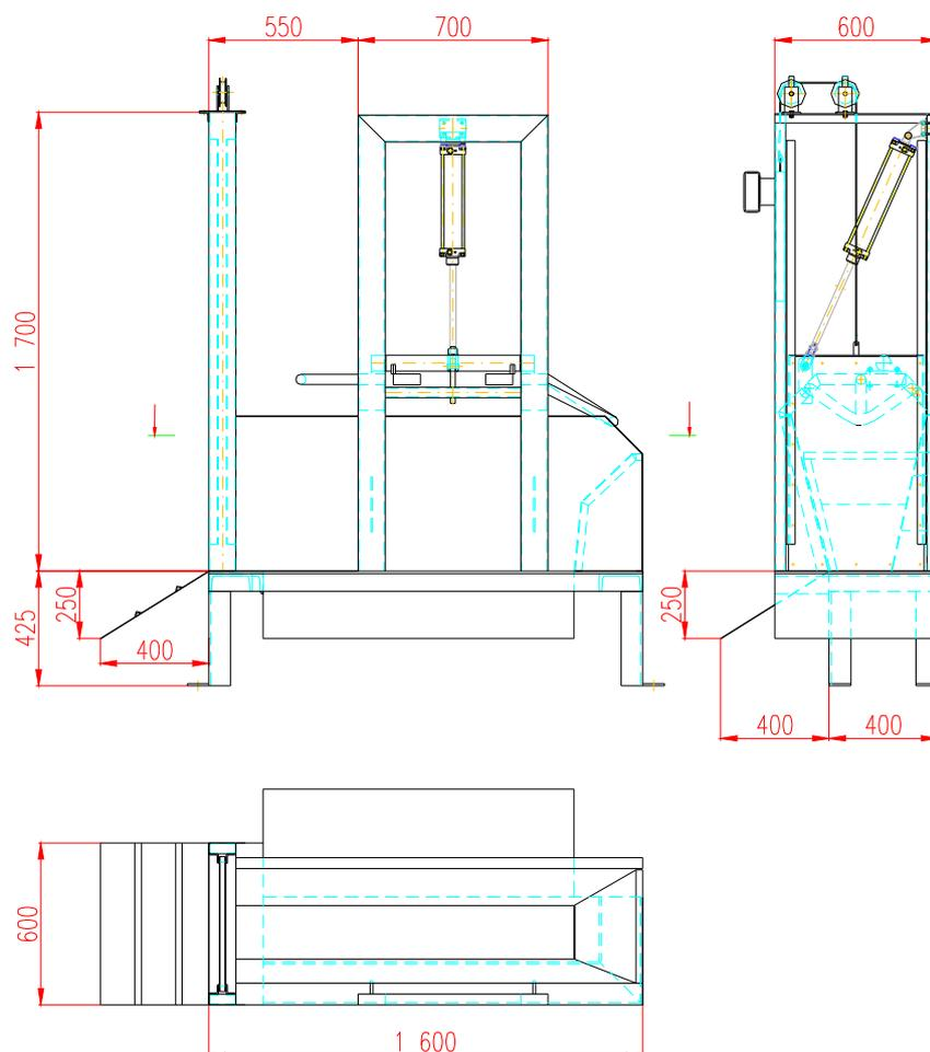
Бокс оглушения применяется для оглушения свиных туш в убойных цехах. Поставляется длиной 1600 мм с левым или с правым расположением. Входные ворота управляются вручную. Масса ворот компенсирована противовесом. Поворотная боковая стенка предназначена для выпадения оглушенной туши из бокса и управляется пневматически. Поверхностная отделка капкана – горячая оцинковка, по желанию возможно поставить полностью из нержавеющей стали.
